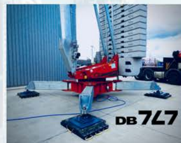
Ingombri del carro e del raggio di rotazione ridotti al minimo
